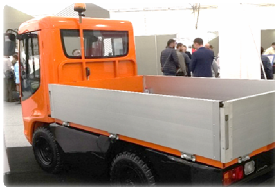
Рис. 5. Электронный макет и опытный образец технологической машины с алюминиевыми бортами
