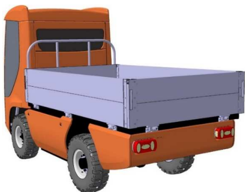
Рис. 5. Электронный макет и опытный образец технологической машины с алюминиевыми бортами
