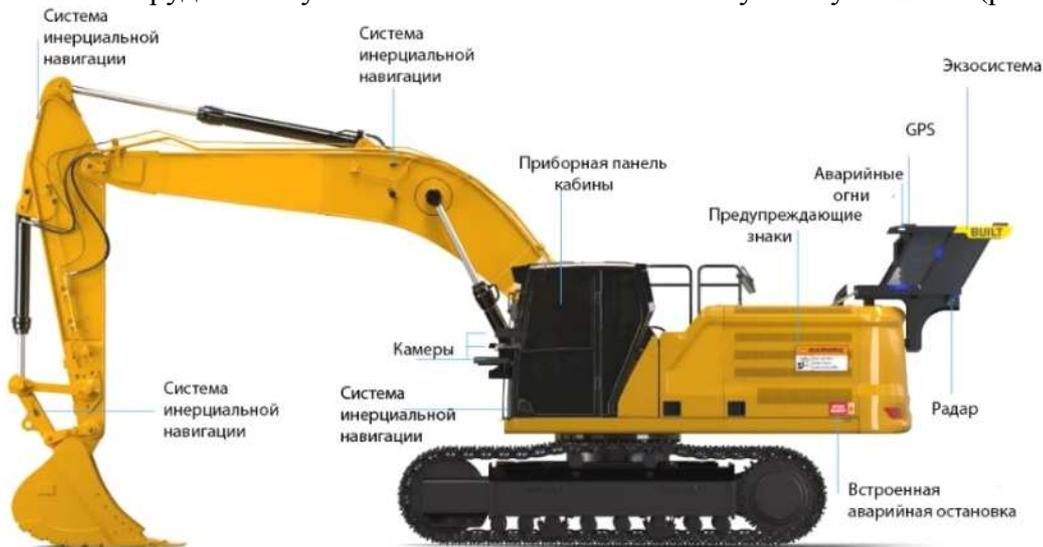
Рис. 2. Схема экскаватора с системами «Индустрии 4.0»
