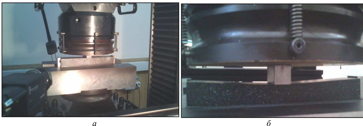
Рис. 4. Деформированное состояние призматического образца: а – начальное состояние, б – конечное состояние
