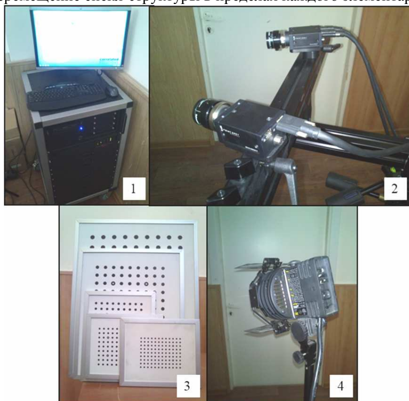
Рис. 1. Система бесконтактного анализа перемещений и деформаций Vic-3D:
