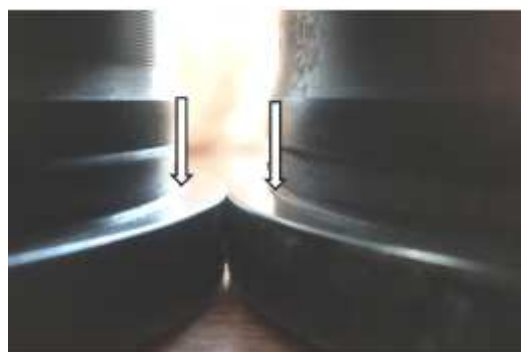
Рис. 4. Сравнение радиуса галтелей гильз 1 (справа) и 2 (слева)
