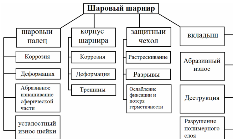
Рис. 1. Виды повреждений шаровых шарниров [1]
