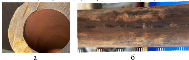
Рис. 2. Коррозионное растрескивание образцов: а – радиальное растрескивание, б – продольное растрескивание
