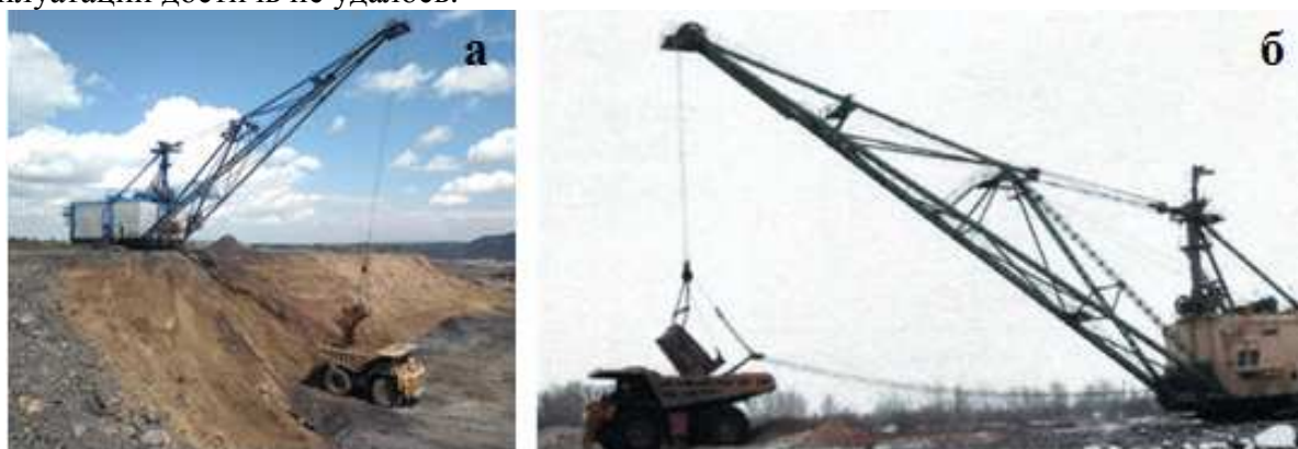
Рис. 1. Погрузка вскрышных пород драглайном ЭШ 6,5/45 в автосамосвал БЕЛАЗ-7548: а – ниже уровня стояния; б – на уровне стояния драглайна
