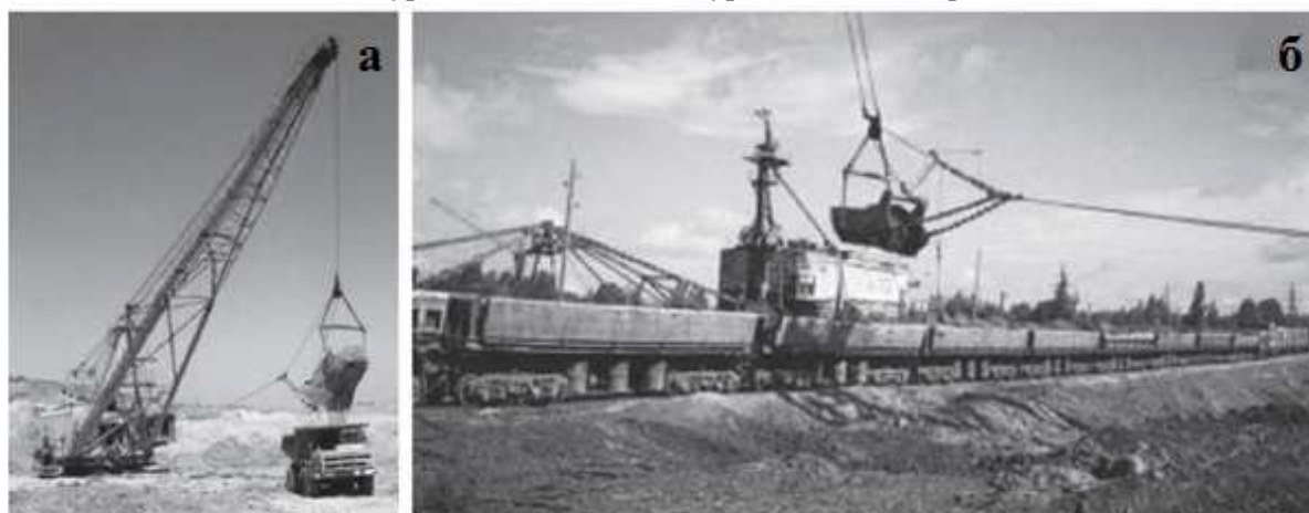
Рис. 2. Погрузка вскрышных пород драглайном ЭШ 10/70 на уровне его стояния на Лучегорском разрезе: а – в автосамосвал БЕЛАЗ-7548; б – в думпкар ВС-105
