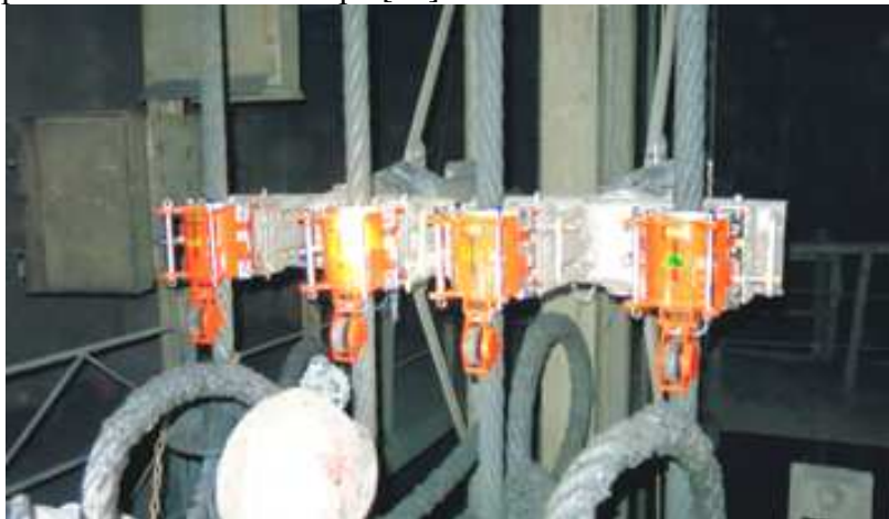
Рис. 5. Навеска магнитных головок при контроле четырех канатов [25]
