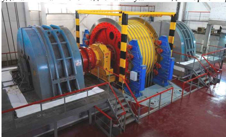
Рис. 1. Шахтная подъемная машина, изготовленная ПАО «Уралмашзавод» [4]
