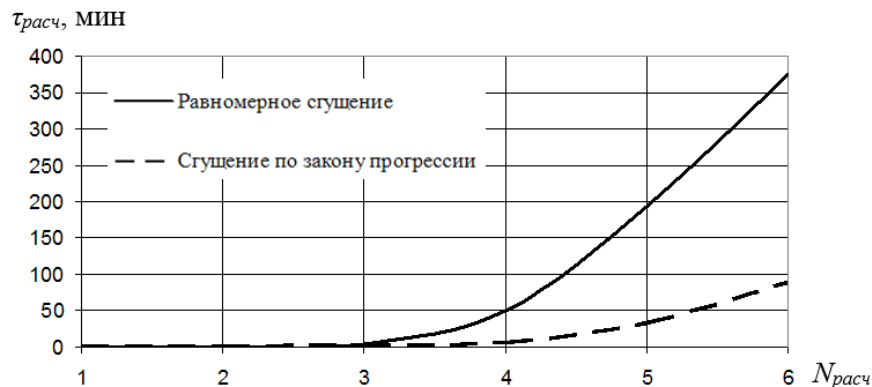
Рис. 7. Распределение вычислительного времени для двух вариантов разбинок
