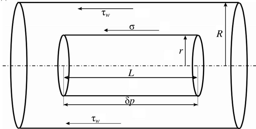
Рис. 1. Схема течения жидкости в трубе
