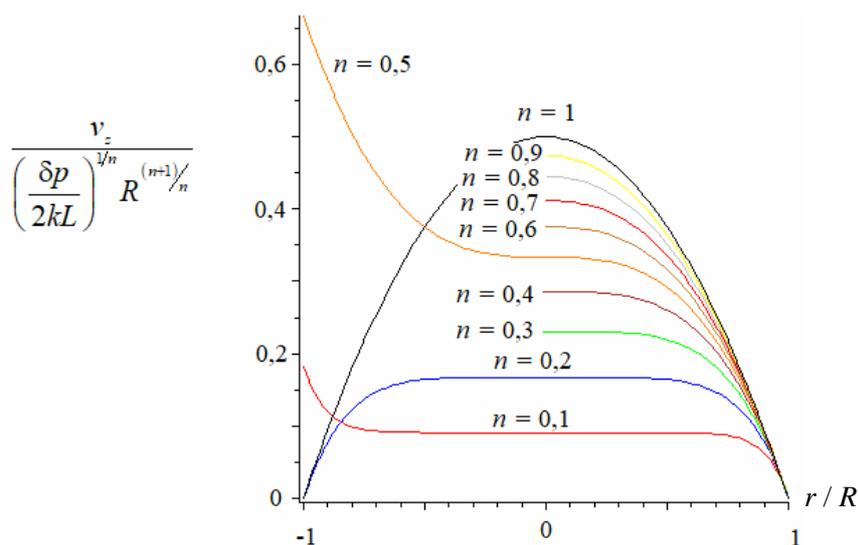
Рис. 2. Профиль безразмерной скорости в зависимости от безразмерного радиуса при течении в трубе
