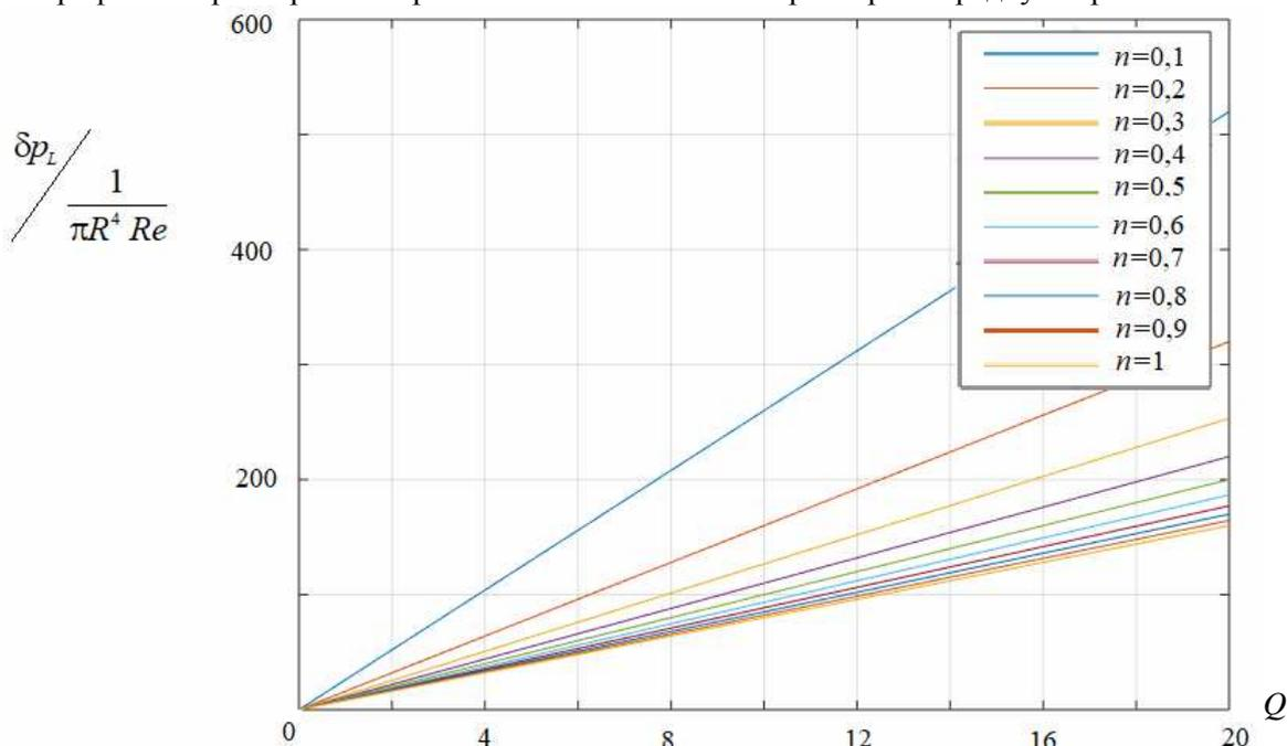
Рис. 3. Зависимость перепада давления от расхода при различных значениях показателя  $n$
