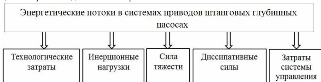
Рис. 1. Схема потребления энергии в системах приводов штанговых глубинных насосах
