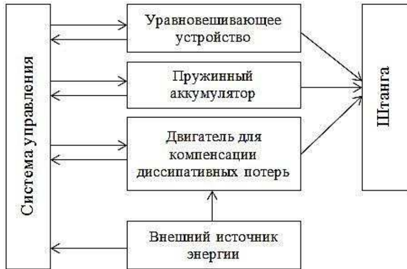
Рис.2. Схема пружинного привода с рекуперацией энергии
