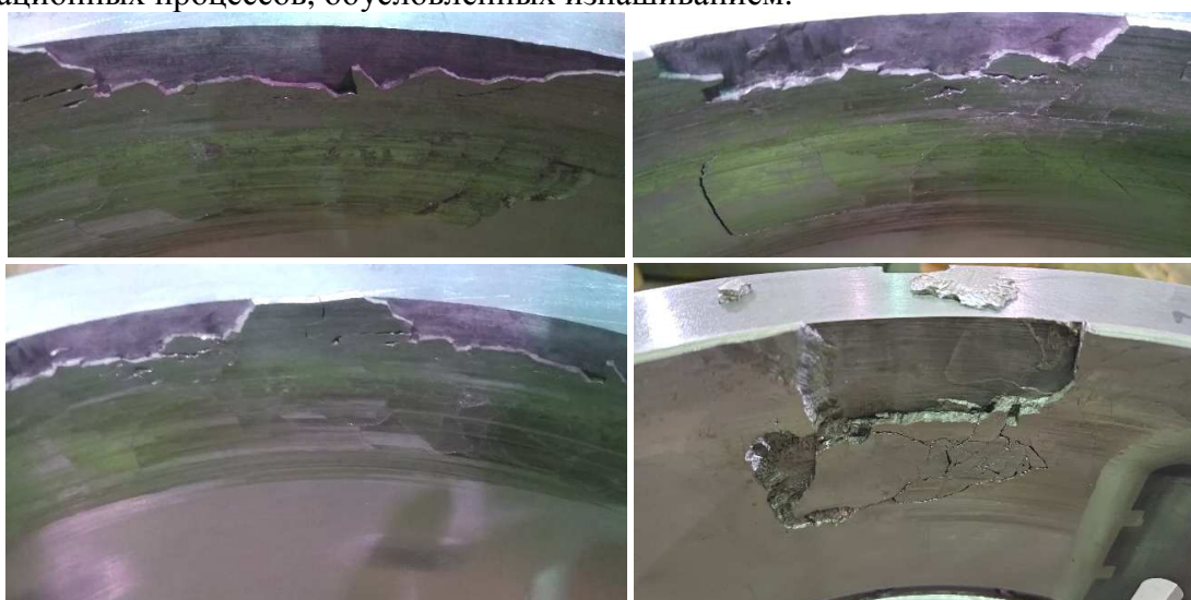
Рис. 6. Разрушение баббитового слоя вкладышей подшипниковых узлов скольжения в течении четырех часов работы при температуре 123°C
