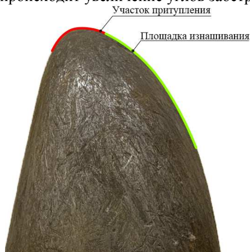
Рис. 1. Вид оконечности зуба ковша экскаватора ЭКГ-5А после работы по взорванному граниту
