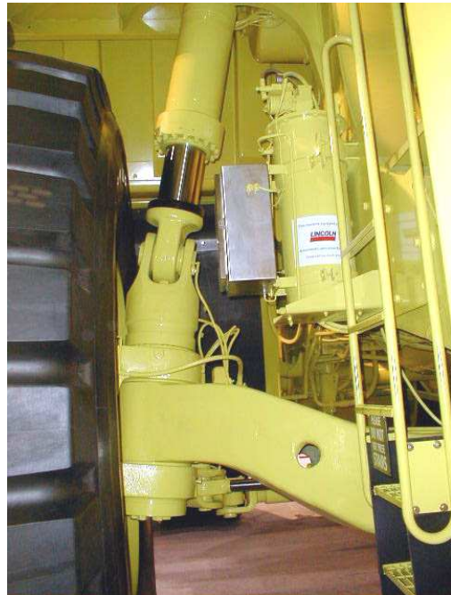
Рис. 2. Передняя подвеска Hitachi EH 4000
