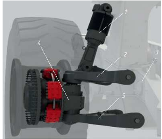
Рис. 5. Схема передней подвески Liebherr T262: 1 – цилиндр пневмогидравлический; 2 – верхний поперечный рычаг; 3 – рама; 4 – поворотная шкворень; 5 – нижний поперечный рычаг
