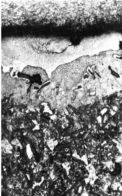
Рис. 2. Микроструктура чугуна АХНММ (х 100) в зоне оплавления поверхности лазером
