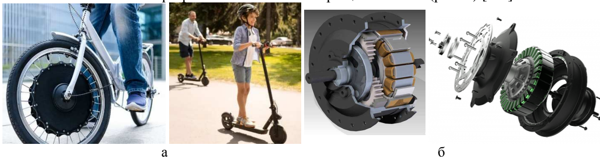
Рис. 1. Примеры малогабаритных ТС с электроприводом (а) и конструкции мотор-колес (б)
