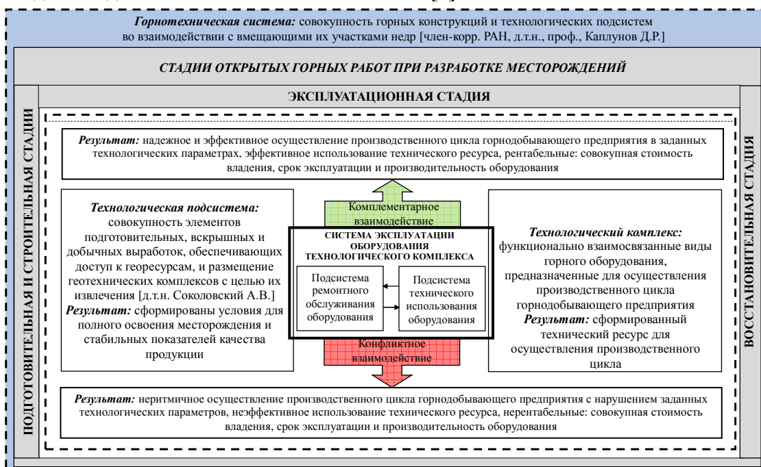
Рис. 1. Взаимосвязь технологической подсистемы и технологического комплекса горнодобывающего предприятия (доработано [4])
