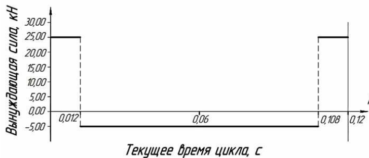
Рис. 1. Исходные данные для проектирования вибрационного устройства с асимметричными колебаниями с произвольным числом ступеней и коэффициентом асимметрии вынуждающей силы, равным k_0
