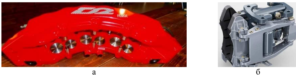
Рис. 1. Прижимающие элементы тормозных механизмов непосредственного действия (а) и с передаточным механизмом (б)
