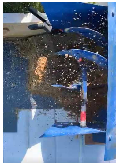
Рис. 6. Переброс транспортируемого материала при работе горизонтального питателя роторного снегоочистителя
