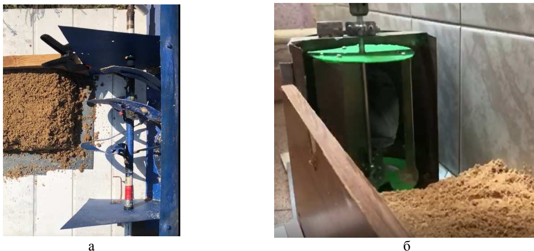
Рис. 1. Экспериментальные установки для исследований: а) горизонтального питателя (вид сверху); б) вертикального питателя (вид сбоку)
