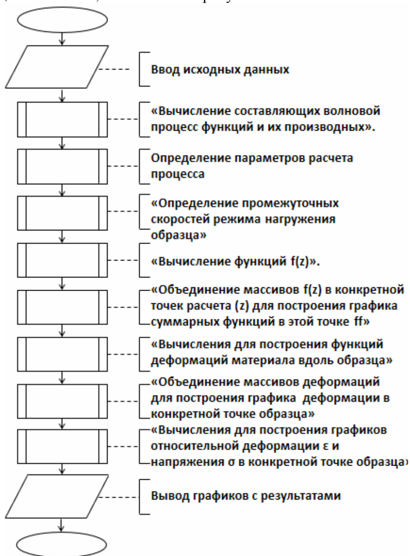
Рис. 2. Блок-схема программы реализации математической модели волнового процесса в образце при мелкоступенчатом его нагружении методом разрывных функций
