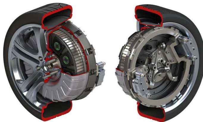
Рис. 3. Автомобиль Mercedes E-Class EV (а) с установленными мотор-колесами (б)
