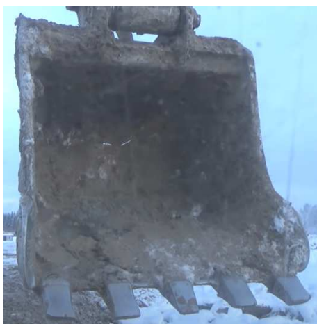
Рис. 1. Ковш экскаватора с налипшим грунтом
