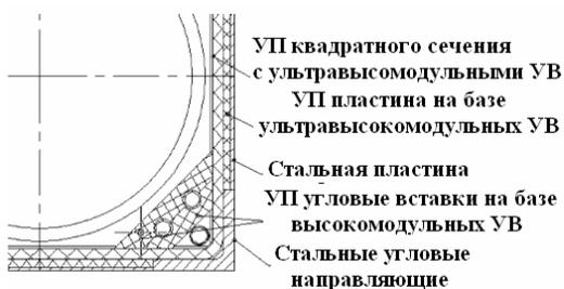
Рис. 2. Конструктивное металло-композитное исполнение корпуса ползуна
