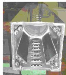
Анализ конструкции гибридной стально-композитной передней бабки для высокоточных шлифовальных станков был проведен в работе [4] (рис. 3). Металло-композитную оболочку передней бабки получали приклеиванием на
