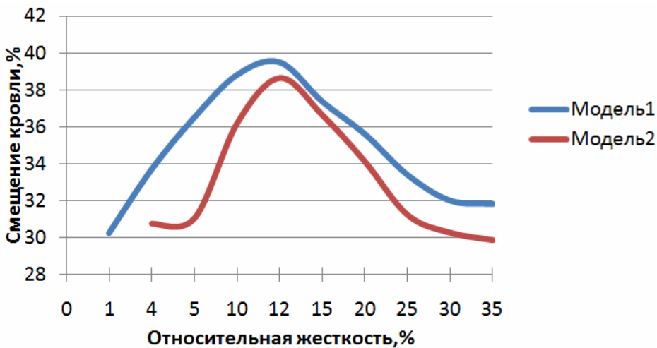
Рис. 3. Зависимость смещения кровли выработанного пространства от относительной жесткости закладочного массива
