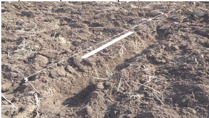
Рис. 4. Профиль пашни после работы плуга ПБС-8
