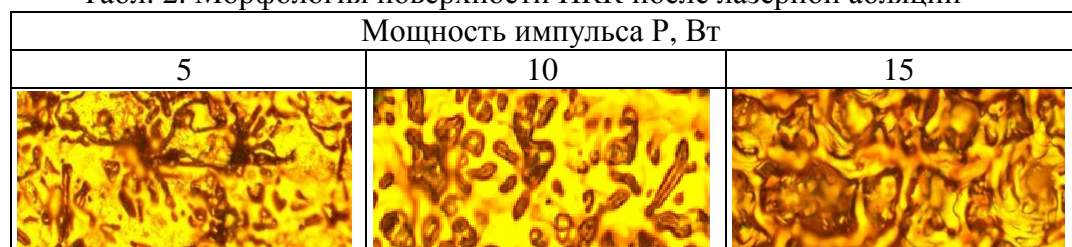
Табл. 2. Морфология поверхности ПКК после лазерной абляции
