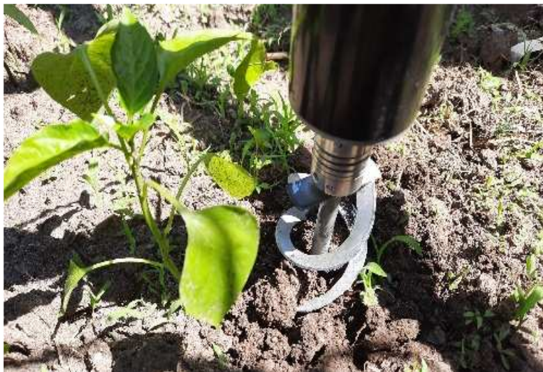
Рис. 5. Общий вид модуля дискретной прецизионной прополки сорняков в рядках: б) вид на фрезу (РО)
