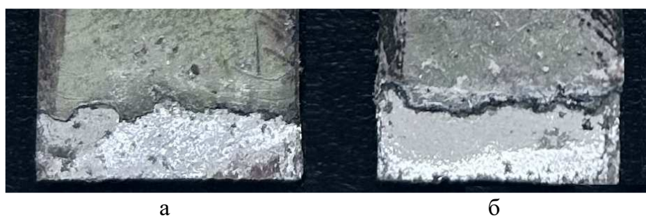
Рис. 5. Внешний вид образцов после испытания при активации поверхности низкотемпературными флюсами: а) на основе хлористого свинца; б) содержащими хлористый кадмий
