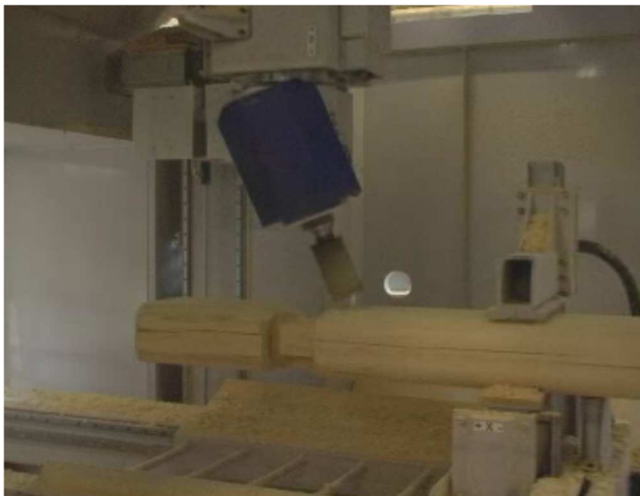
Рис. 7. Обработка элементов соединения на пятиосевом станке
