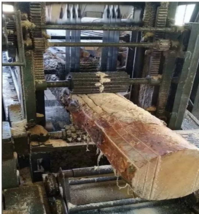
Рис. 5. Рамная пилорама р63, получение прямоугольного бруса
