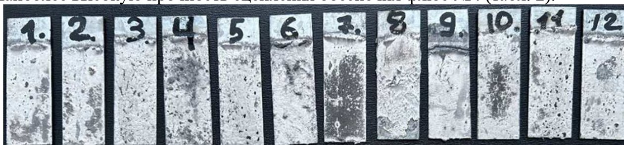
Рис. 2. Смачивание магнием оцинкованной стали и формирование магниевого покрытия при температуре окунания в магниевый расплав 750°C
