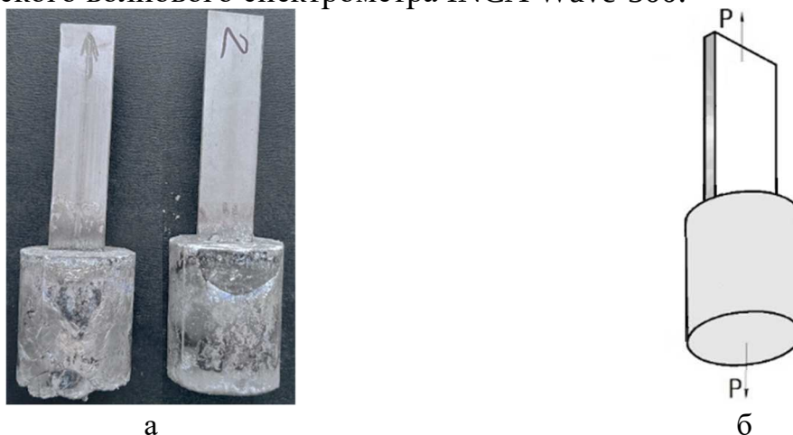
Рис. 1. Испытания прочности сцепления компонентов композиционного материала: а) образцы для испытания; б) схема испытания
