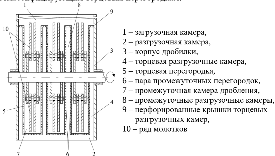
Рис. 1. Схема продольного разреза молотковой дробилки с промежуточными камерами дробления
