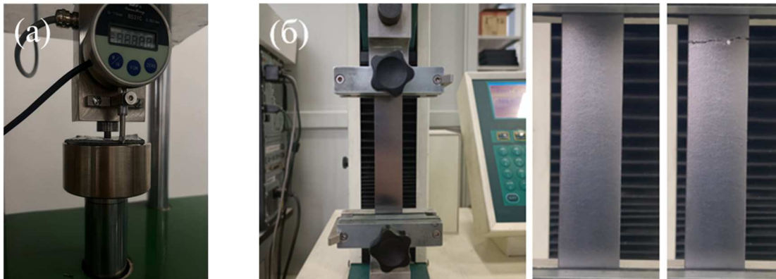
Рис. 3. а – испытания СВУ графитовой фольги на установке HLYS-5, б – испытания на разрыв ГФ
