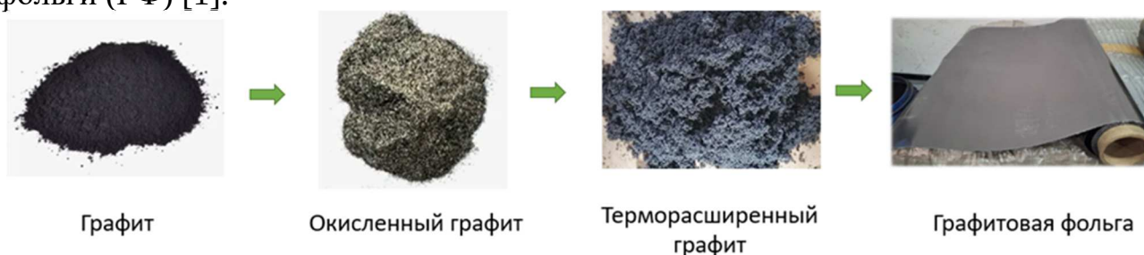
Рис. 1. Схема получения терморасширенного графита и ГФ
