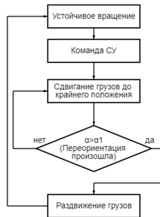
Рис. 4. Принципиальные алгоритм и логика закона управления
