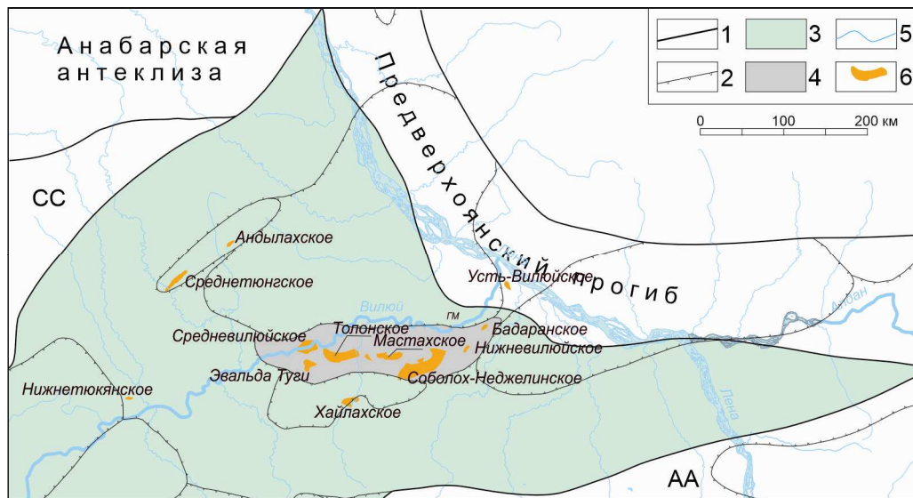
Рис. 1. Обзорная тектоническая схема Хапчагайского мегавала: 1 – границы надпорядковых структур, 2 – границы структур 1 порядка, 3 – Вилюйская синеклиза, 4 – Хапчагайский мегавал, 5 – гидросеть, 6 – газопыльные и газоконденсатные месторождения
