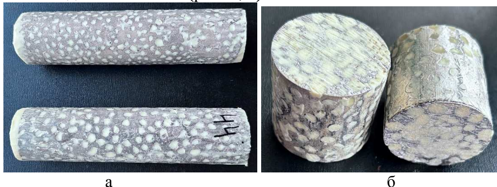
Рис. 2. Образцы металлополимерного композита для испытания прочности: а) при растяжении; б) при сжатии
