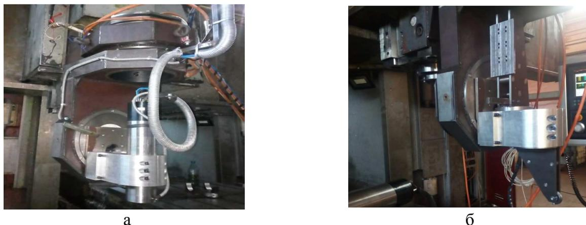
Рис. 3. Вариант двухосевой шпиндельной головки (а) и вариант накатного устройства (б)
