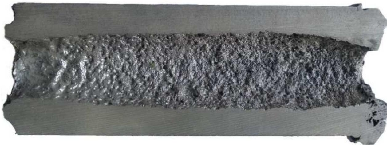
Рис. 2. Продольный разрез полый цилиндрической заготовки из силумина, полученной методом намораживания
