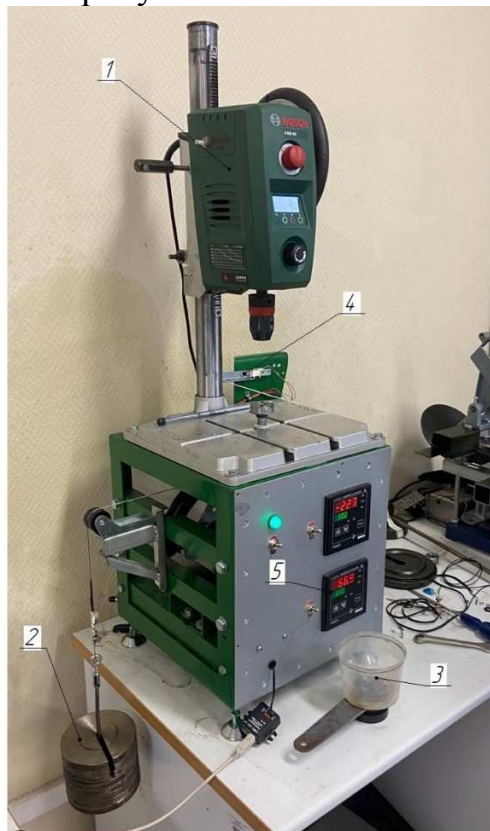
Рис. 1. Испытательная установка для определения коэффициента трения
