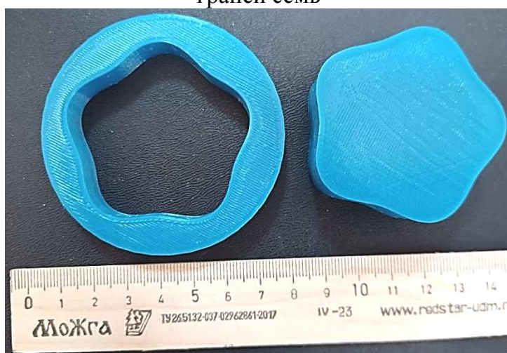
Рис. 3. Модели профильного соединения вал-ступица с контуром в виде синусоидальной кривой с числом лучей пять
