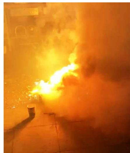
Рис. 4. Заливка формы с гранулами из гидрокарбоната натрия
