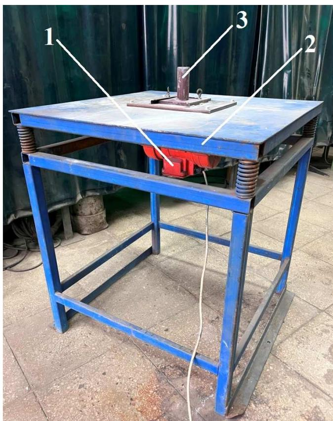
Рис. 1. Лабораторный вибростол, где: 1 – вибратор ИВ-99Б; 2 – плита; 3 – быстросъемная форма
