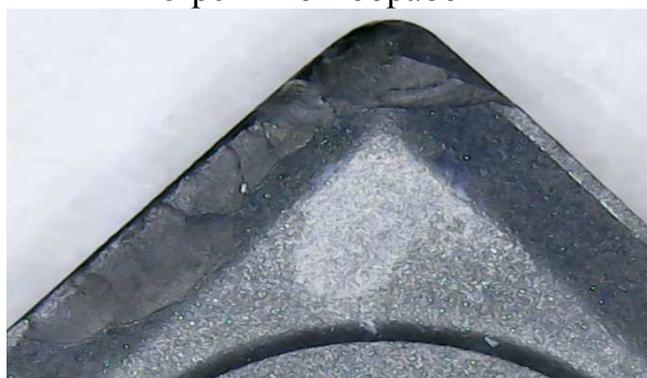
Рис. 4. Износ пластины после обработки 24 режимом обработки
