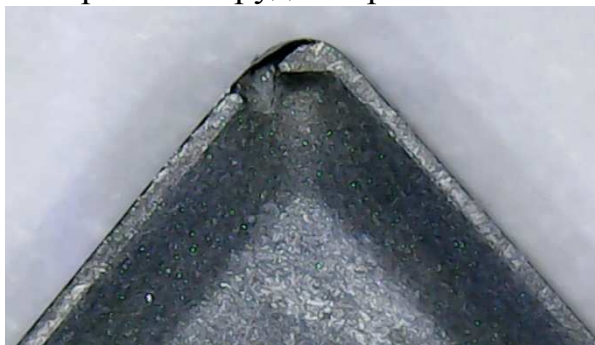
Рис. 1. Износ пластины после обработки 1 режимом обработки
