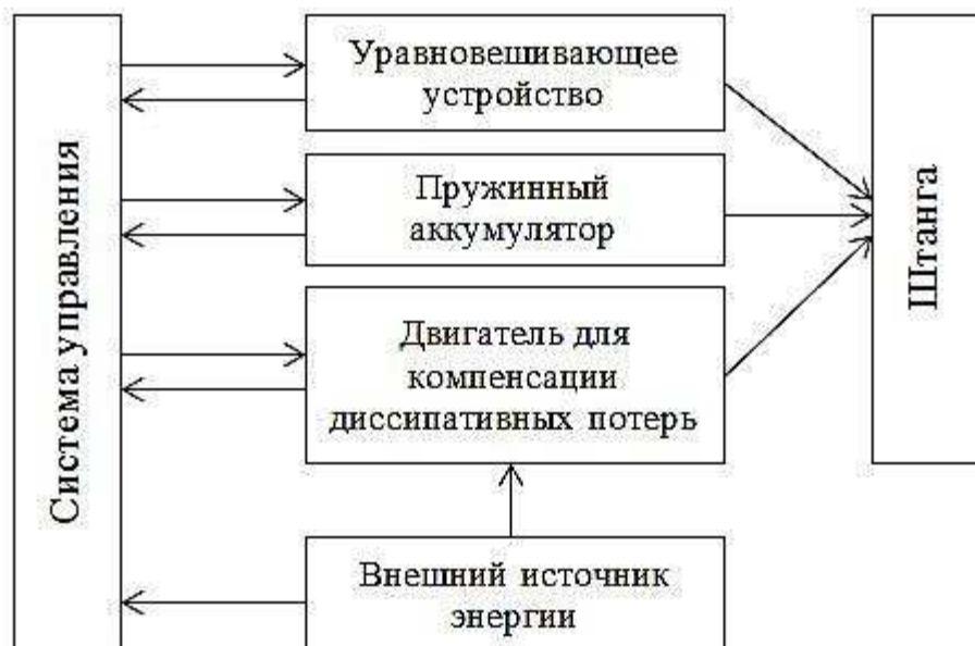
Рис. 2. Схема мехатронного пружинного привода с рекуперацией энергии
