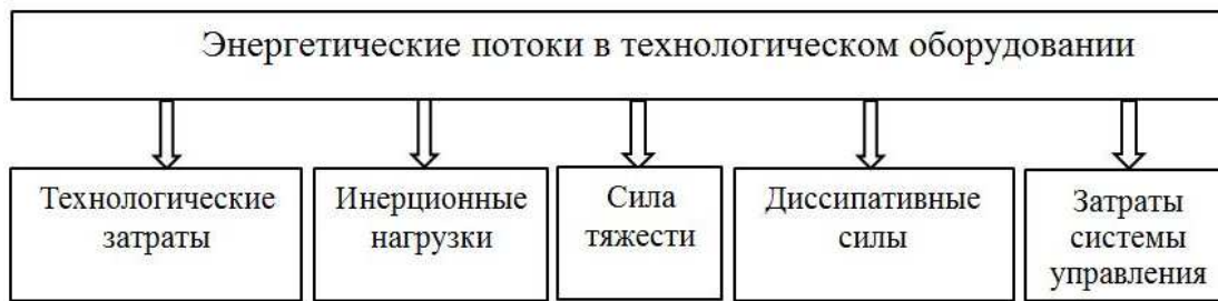
Рис. 1. Схема потребления энергии в современном технологическом оборудовании
