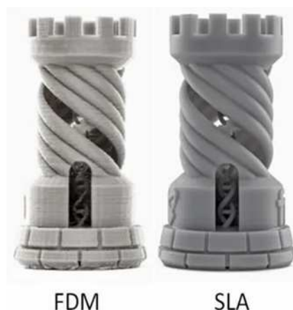
Рис. 3. Сравнение печати FDM и SLA
