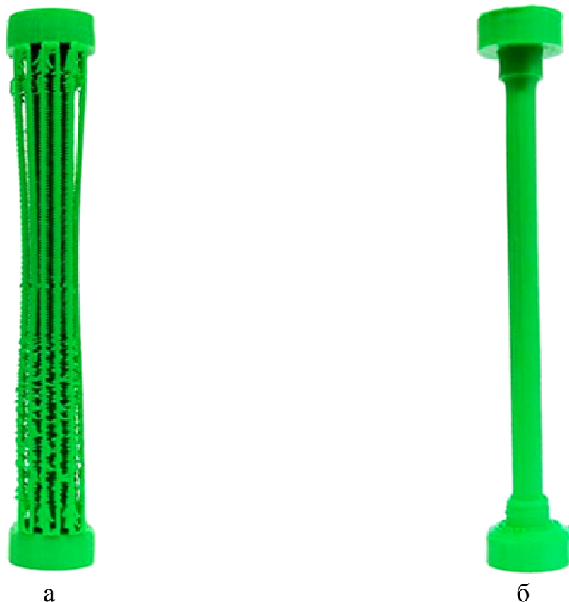
Рис. 2. Пример образца (применяется для испытаний на разрыв), требующего создания поддерживающих элементов для получения нависающих плоскостей: а – образец с элементами поддержки; б – тот же образец после удаления элементов поддержки
