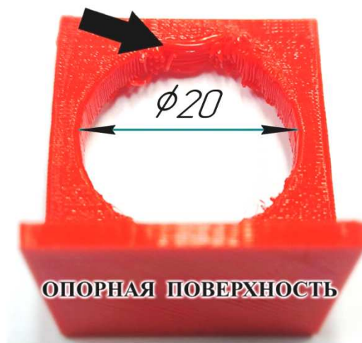
Рис. 2. Провисание нити (указано стрелкой) при печати нависающей поверхности изделия из PLA-пластика
