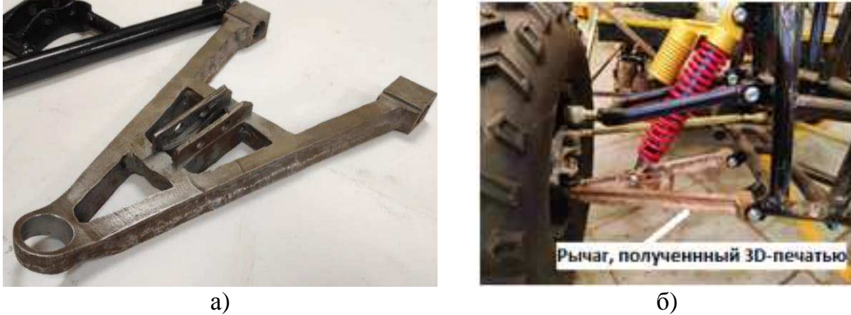
Рис. 1. Обработанная деталь рычаг (а) и рычаг, установленный в переднюю подвеску ТС (б)
