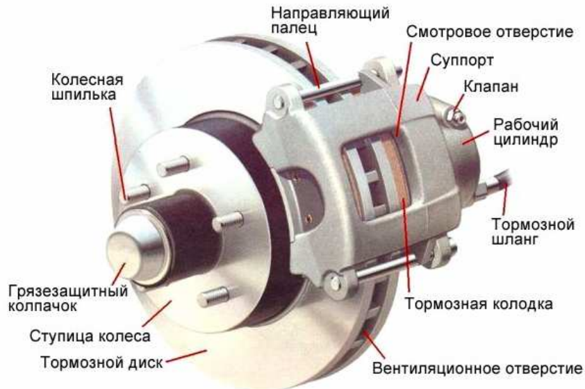
Рис. 1. Устройство тормозного механизма с вентилируемым тормозным диском
