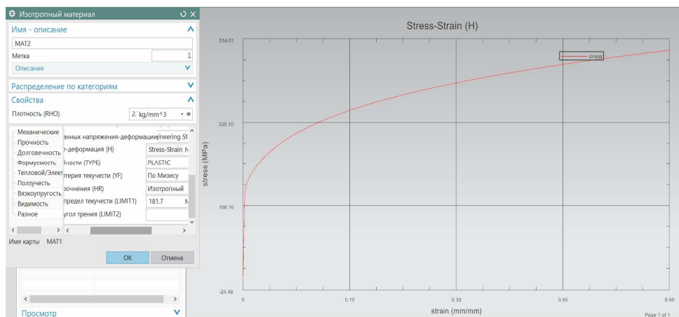
Рис. 1. Задание кривой деформирования упругопластического материала
