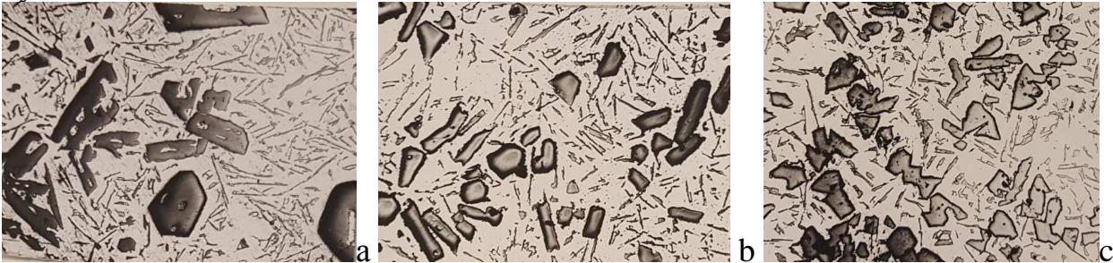
Рис. 3. Микроструктура сплава Al-20%Si. а) Без выдержки (Сразу после ввода лигатуры Cu-P); б) Выдержка расплава - 20 мин; с) Выдержка расплава - 6 часов
